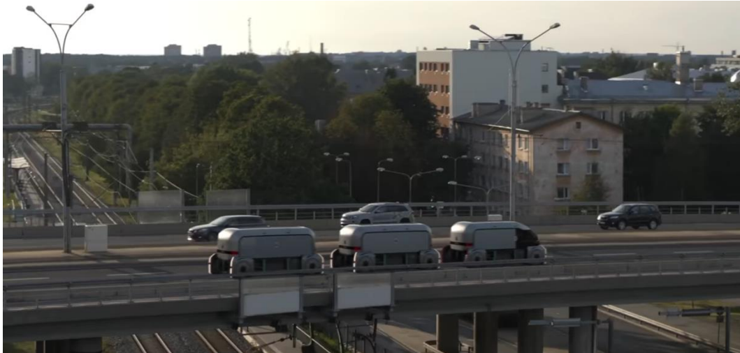
圖 3 自駕載具在非常短的安全距離下行駛，除了依賴影像辨識與光達辨識，必須使用載具與載具的通訊(V2V)才能達成。概念車圖片來源為法國車輛製造商雷諾汽車(Renault)。
